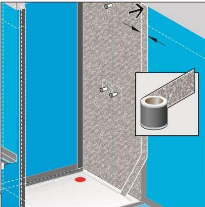
**C 15.** Bleibt am Ende einer abdichtenden Fläche der schwarze Randstreifen einer Bahn stehen, so ist dieser mit einem **100 mm breiten Abschlussstreifen** zu überkleben.
