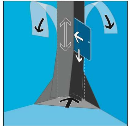
**B 11.** Innenecke oben beginnend ansetzen. Abdeckfolien nach unten abziehen. Das **Eckklebeband** wie in Bild **B 6** anbringen. Mit Mausemkel andrücken.
