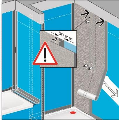
**C 14.** Die nachfolgenden Dichtbahnen auf den **vliesfreien** Randstreifen (50 mm) der jeweils vorhergehenden Dichtbahn **überlapend** aufsetzen.
