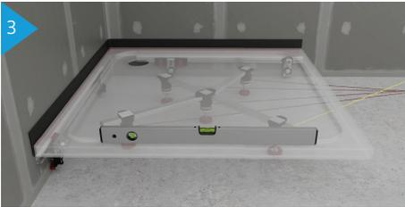
Zuerst mit der gelben Zugschnur auf Höhe ausrichten, anschließend die übrigen 4 Stellfüße mit den Zugschnüren bis gegen den Boden ziehen
