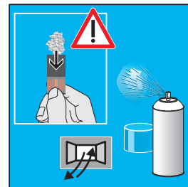
A 5. Wenn der Klebeversuch negativ ausfällt, kann der Sprühprimer herangezogen werden. Sprühprimer bei geöffnetem Fenster oder Tür im Abstand von 20-40 cm leicht aufsprühen. (Verarbeitungshinweise des Herstellers beachten!) Neul Handwerkerfreundliches Primern (10 min. Trocknungszeit).
